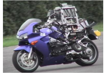
人間の操縦動作解析を基に構築した二輪車を操縦するライダーロボット
