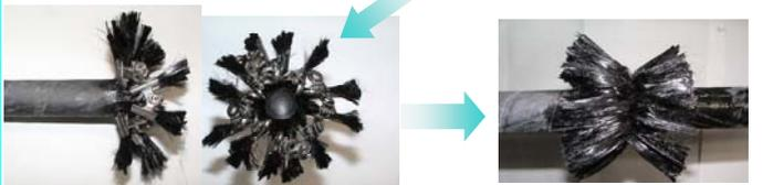
3. 燃焼して露出させた繊維をアセトンで洗浄後12本に分ける
